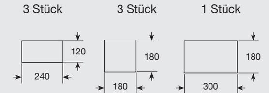
Der restliche Stein im Format 18/24/10 cm (1 Stück/Satz) wird zu der Fläche hinzugefügt.
